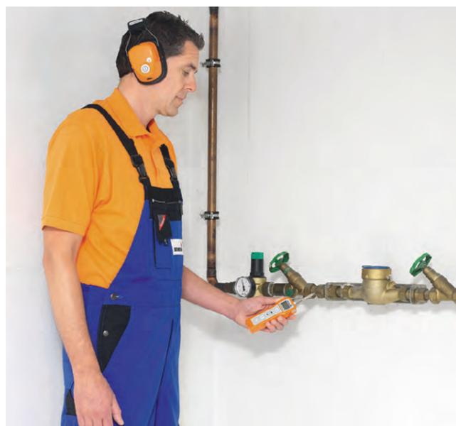
ПОИСК ВНУТРИДОМОВОЙ УТЕЧКИ НА ТРУБОПРОВОДЕ
