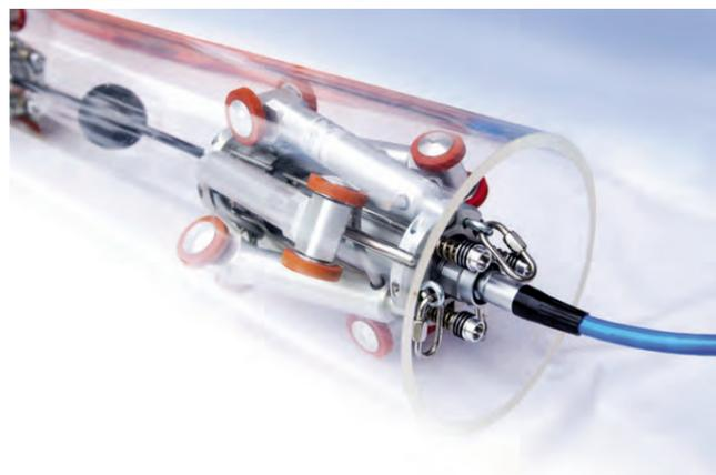
Краб-Роботы открывают новые возможности для визуального осмотра трубопроводов с большим количеством поворотов и вертикальных участков, диаметрами от 50 мм до 650 мм и более.
