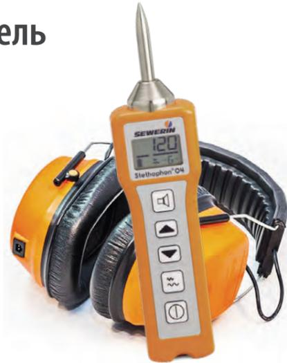
Чтобы максимально упростить обнаружение утечки, Stethophon® 04 не только показывает уровень шума, но и отображает его в цифровом виде. Самые низкие измеренные шумы предыдущего и текущего значений отображаются в числовом значении.
