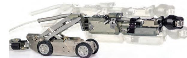
РОБОТ L135 CROSS + КАМЕРА KS135 С САТЕЛЛИТНОЙ СИСТЕМОЙ ДЛЯ ОСМОТРА ОТВОДОВ
