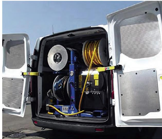
Компактные прочистные машины PTC Italiana могут быть установлены в компактные автомобили, что позволяет производить работы в труднодоступных местах, там где не проедет тяжелая коммунальная техника: в исторических центрах городов, на пешеходных тротуарах, подземных парковках, узких дворах многоквартирных домов.
