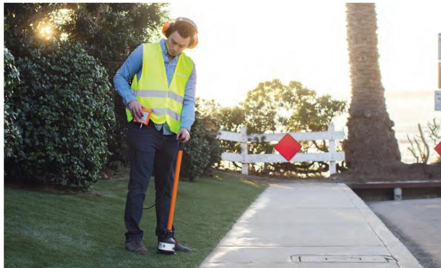
ТЕЧЕИСКАТЕЛЬ AQUAPHON® A150 + ГРУНТОВОЙ МИКРОФОН ВМ200
